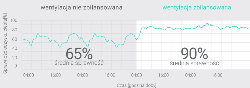
Wykres przedstawia wyniki pomiarów wykonanych w warunkach rzeczywistych w Krakowie w dniach 13.02.2017 - 17.02.2017 dla rekuperatora AirPack Home 300h
